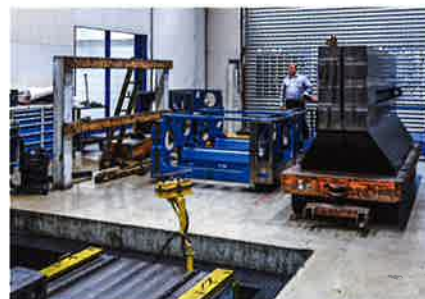
Anschließend werden die Teile wieder zurück in den Temperierungsbereich gebracht und von dort in die Vorkammer des Messraums.
