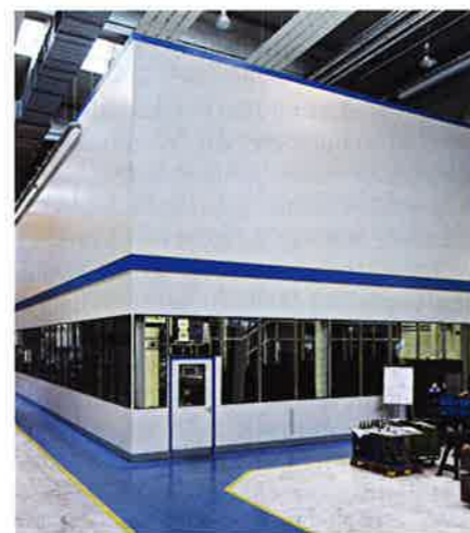
Um die klimatischen Bedingungen zu gewährleisten, ließ KBA von der Nerling Systemräume GmbH einen Präzisionsfertigungsraum mit Vortemperiererraum einrichten.
