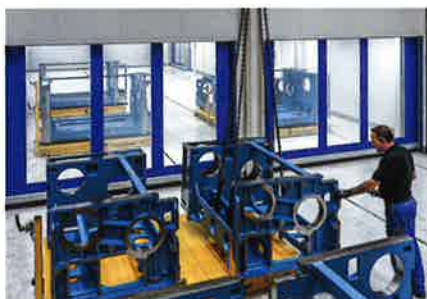
Nach dem Prinzip First In – First Out werden die Teile dem „DIXI 270“ zugeführt und mit einer Genauigkeit von \pm 10 \mu\text{m} bearbeitet.
